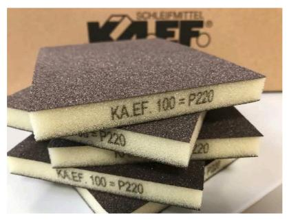
Durch den Einsatz von Schaumstoff als Trägermaterial unterscheiden sich gestreutes Korn und das erzielte Schliffbild. Wir geben daher an: Korn = gestreutes Korn und Schliffbild = entspricht ca. dem Ergebnis von Schleifpapier (z.B. Korn 100 = ca. P 220). Bitte prüfen Sie selbst. Ein, wenn auch geringer, Kornausbruch ist normal. Werkstücke sind nach der Bearbeitung zu reinigen.
